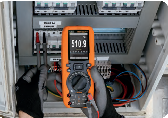
光伏组串开路电压测量
