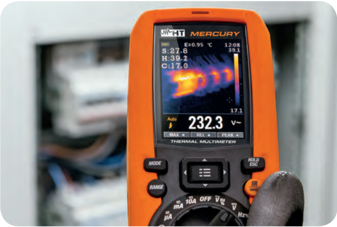
开关柜红外热图测量
