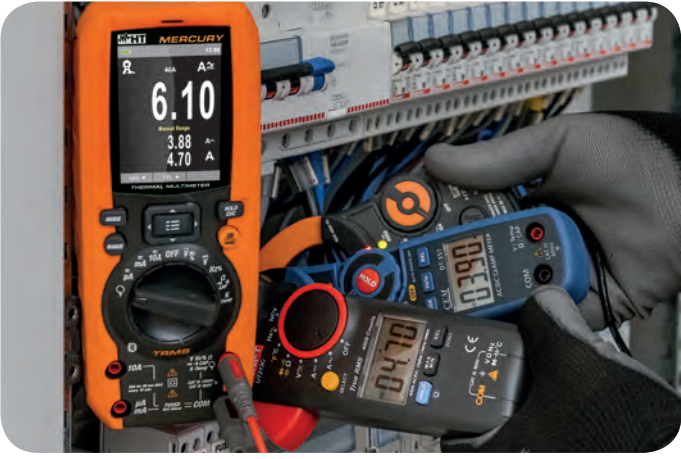
AC+DC 电流测量对比: 3.9A 电流钳, 4.7A 真有效值电流钳, 6.1A AC+DC 真有效值电流钳.
