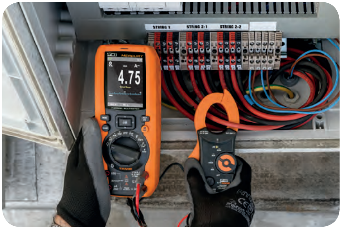
太阳能电站组串电流测量
