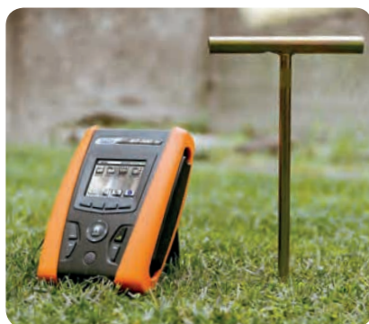
使用伏安法测量接地电阻
