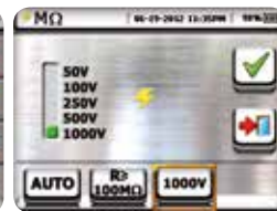
选择测量的检测电压与最小限值
