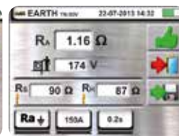
接地电阻测量结果OK
