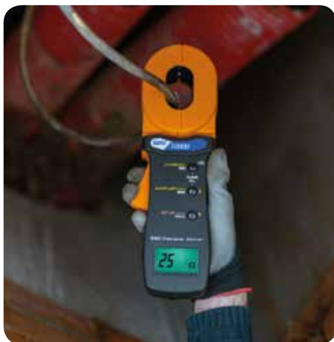
使用钳形表T2100测量接地电阻
