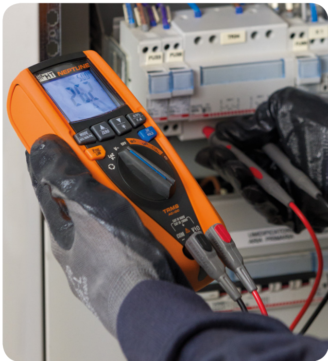
用测试表笔进行电压测量
