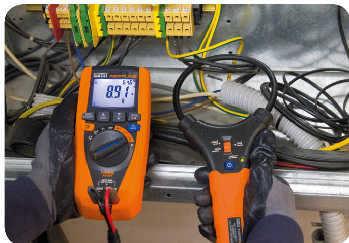
通过柔性电流钳 F3000U 测量电流。
