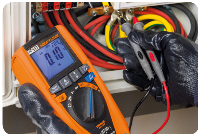
保护导体的连续性测试
