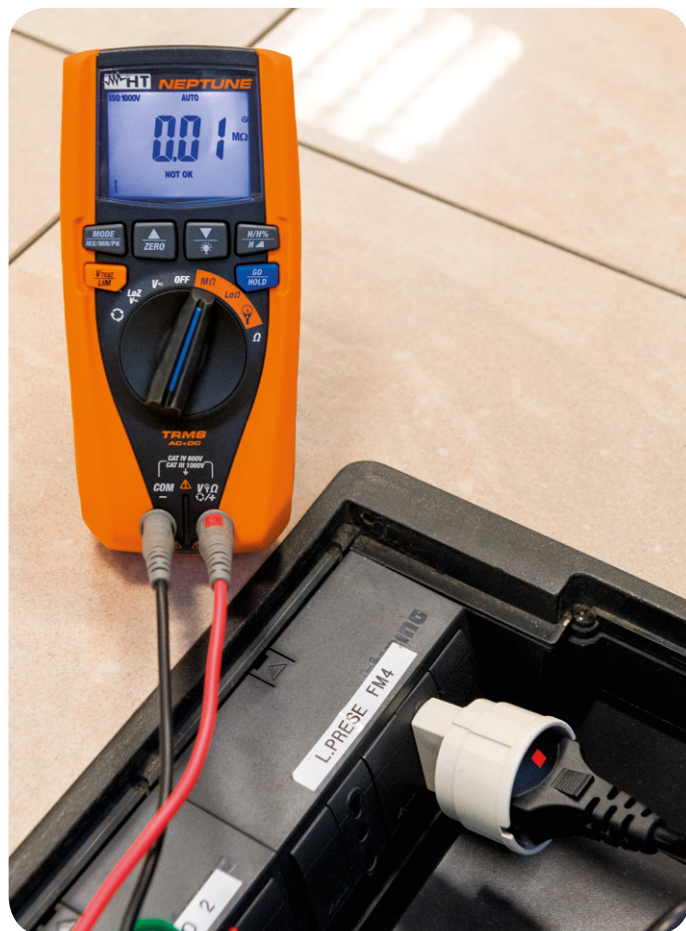
测量绝缘电阻 (选配的 C2065 插头适配器)。
